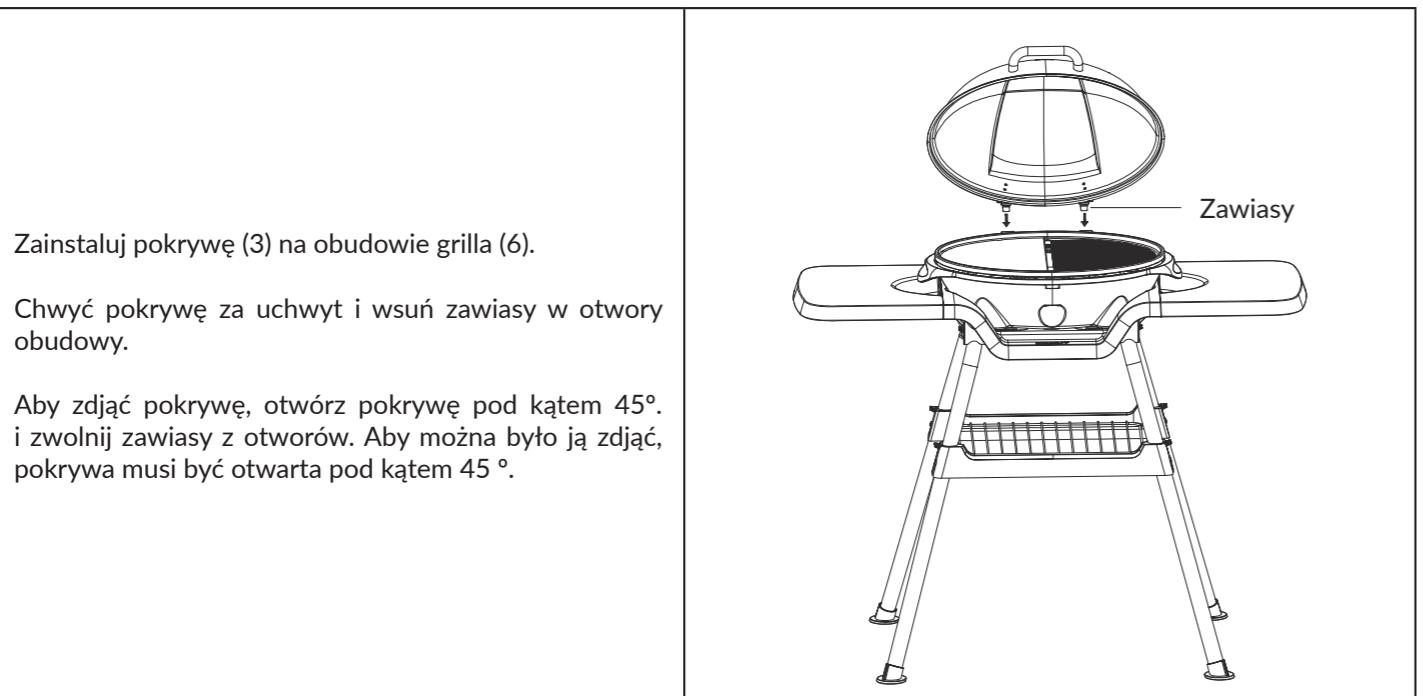
Zainstaluj pokrywę (3) na obudowie grilla (6).
