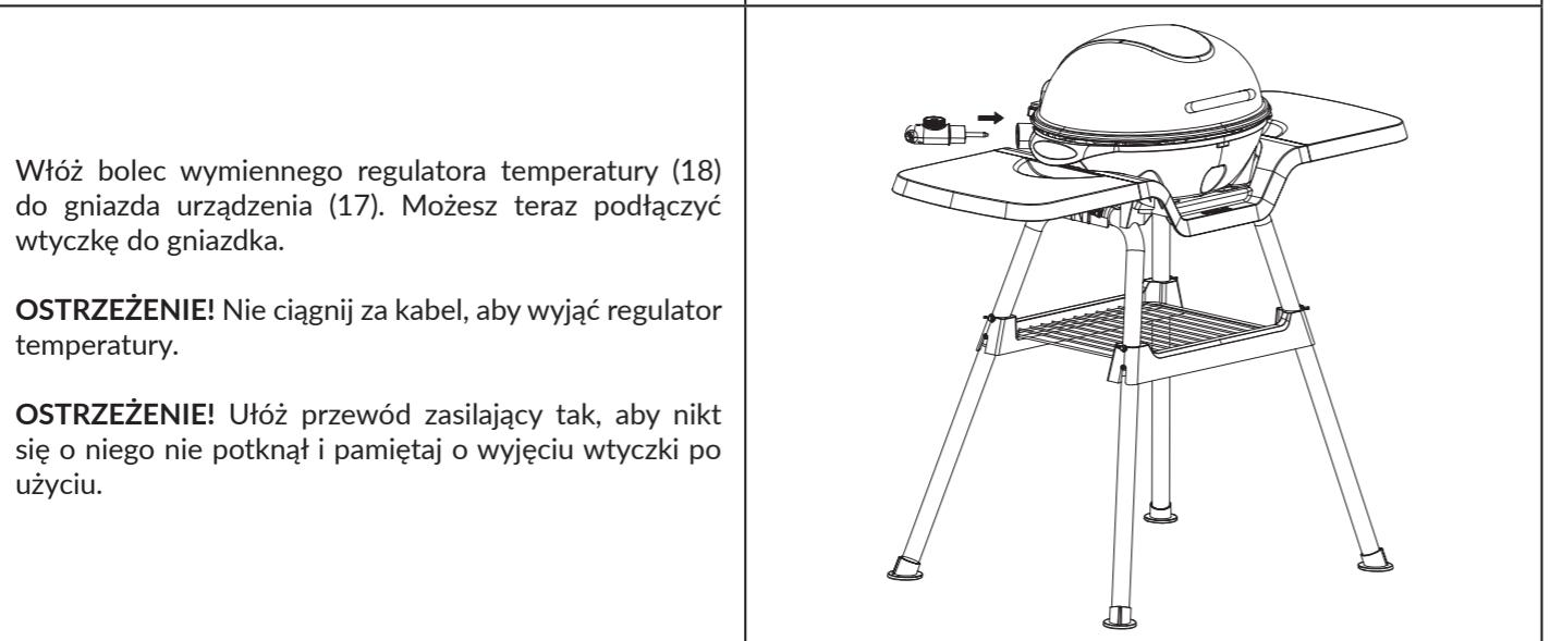
Włożyć bolec wymiennego regulatora temperatury (18) do gniazda urządzenia (17). Możesz teraz podłączyć wtyczkę do gniazdka.
