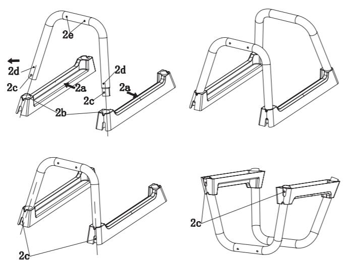
Włóż prostą rurkę (11) ze stroną zwężoną do otworu rury w kształcie litery U (10) bez zwężenia. Dopasuj otwory na śruby (1c) i (2c), dokręć otwory śrubą (B).
