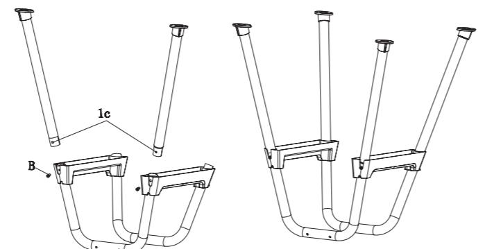
Po zamontowaniu prostej rury (11) odwróć ramę z powrotem tak, aby stała teraz pionowo.
